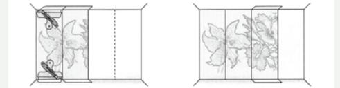
壁面タイプの壁紙は規格幅450mmのロールを施工現場で貼り合わせ、完成させます。接着は通常のでんぶん糊等（壁紙用）で行いますが、設置場所の壁側に糊を塗り（むこうノリ）施工します。
